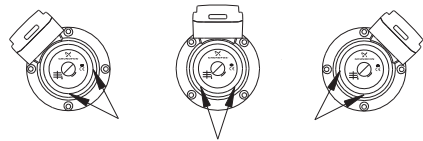
Рис. 5 Расположение клеммной коробки у одинарных насосов
