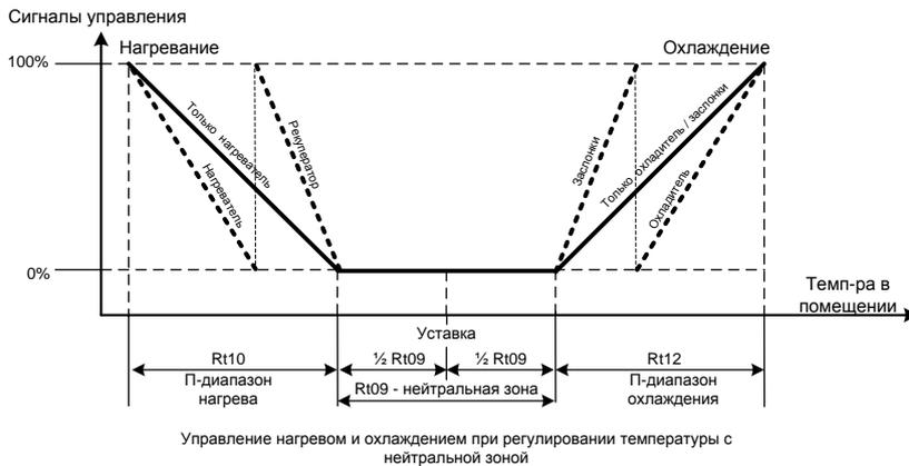
сигнал для управления нагревателем и (или) рекуператором. Если производится управление рекуператором и нагревателем, то сигнал 0-100%, сформированный регулятором температуры, делится на две последовательные части, первая из которых используется для управления рекуператором, вторая – для управления нагревателем. Граница между сигналами управления задается с помощью параметра  $Rt24$  (см. п. «регулирование температуры приточного воздуха»).
