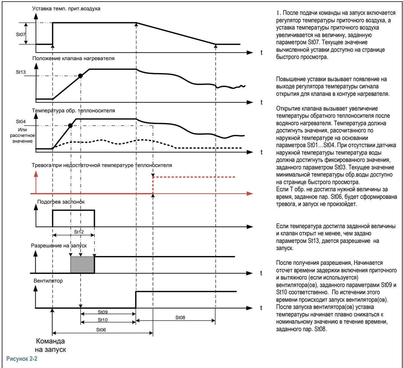
Если наружная температура выше значения параметра St01 или, в случае отсутствия датчика наружной температуры, переключатель Winter/Summer (зима / лето) установлен в состояние «лето», то процедура прогрева теплообменника и заслонок не производится (см. рисунок 2-3).
