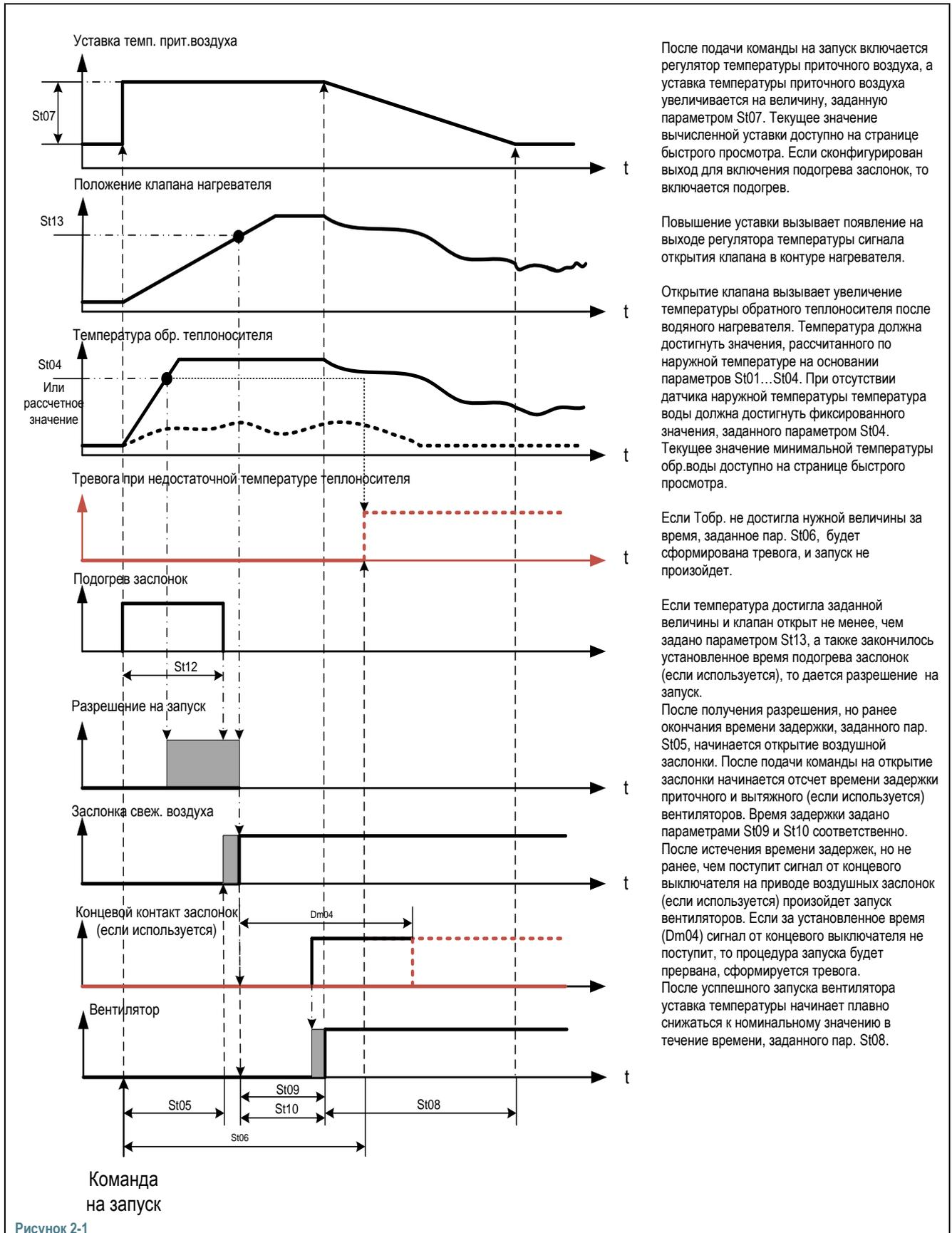
Графики, показанные на рисунке 2-2, иллюстрируют выполнение процедуры запуска установки в зимнее время при наличии сконфигурированного выхода управления воздушной заслонкой.
