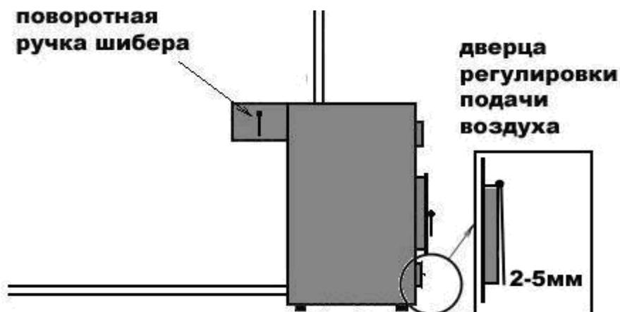
10. - когда топлива в топке останется меньше 1/10 части от полной загрузки, можно немного приоткрыть дверцу регулировки подачи воздуха, дополнительно примерно на 5мм, сохраняя температуру теплоносителя на выходе, до полного сгорания топлива или доложить топлива,
