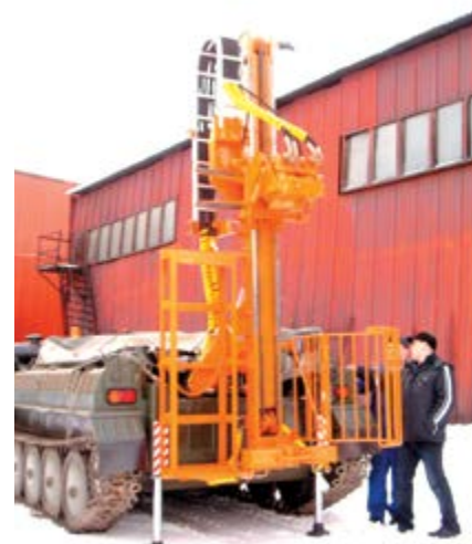
Машина в рабочем положении с ограждением рабочей зоны (ДОРЗ)
