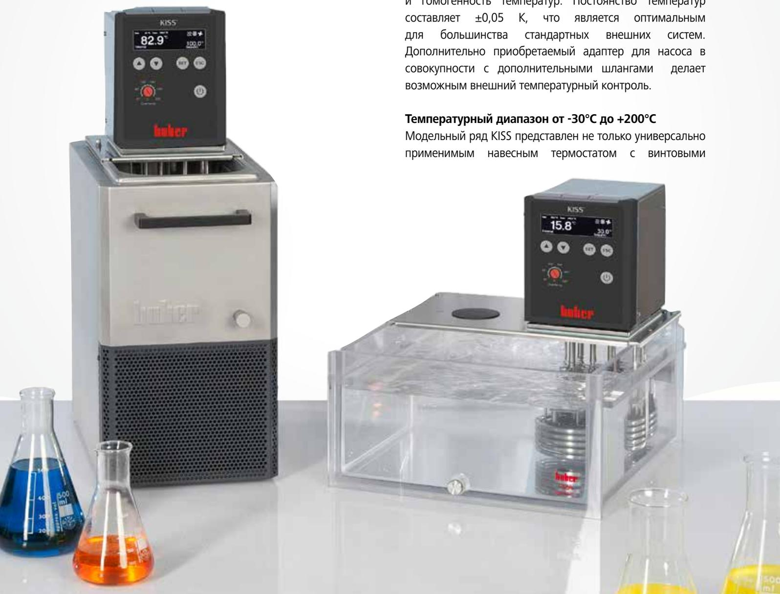
клеммами, но и различными термостатами с открытыми ваннами и термостатами-циркуляторами. Термостаты с открытыми ваннами оснащаются как ваннами из поликарбоната (до +100°C), так и ваннами из нержавеющей стали (до +200°C). Объем ванн, в зависимости от модели, составляет от 6 до 25 литров.
