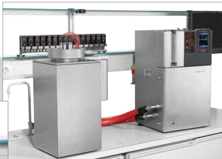
Калибровочные ванны Huber используются в управлении качеством продукции на производстве и в научных исследованиях. Модульная концепция базируется на сочетании калибровочной ванны и термостата Unistat. Термостат определяет рабочий диапазон и скорость изменения температуры.
