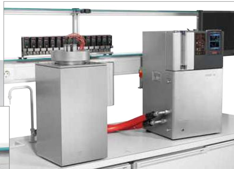
Калибровочные ванны Huber используются в управлении качеством продукции на производстве и в научных исследованиях. Модульная концепция базируется на сочетании калибровочной ванны и термостата Unistat. Термостат определяет рабочий диапазон и скорость изменения температуры.
