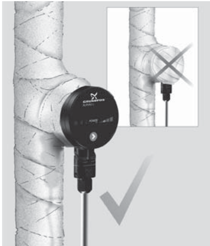
Рис. 6 Изоляция корпуса насоса
