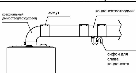
⚠ В случае работы при температуре воды на выходе из котла ниже 50<sup>0</sup>С (например, при использовании датчика наружной температуры) требуется обязательная установка конденсатоотводчика.
