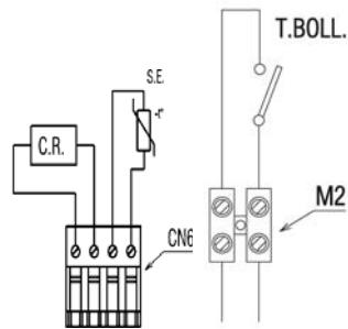
Низковольтные потребители подключаются так, как показано на схеме, к разъёму CN6 и M2.
