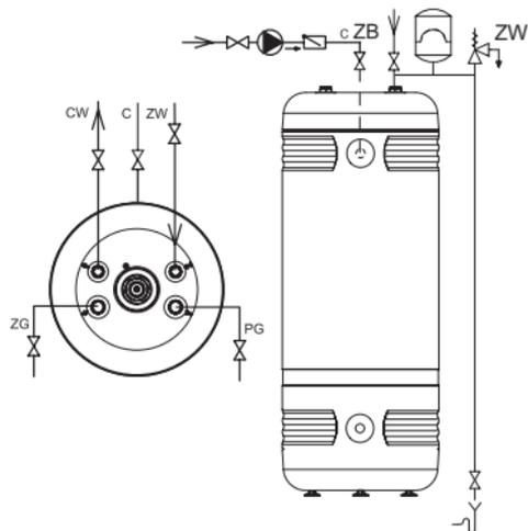
Подключение к отопительной системе следует осуществить при помощи соединительных патрубков 1", а перед патрубками установить отсечные краны. В системах с принудительной циркуляцией (с насосом в отопительной системе), для того, чтобы теплообменник имел параметры производительности указанные в пункте „Технические данные“, следует обеспечить соответственный уровень протока теплоносителя.
