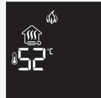
**3** Установка температуры отопления
