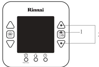
\* Для установки нужного режима по температуре бойлера (термистор), войдите в Сервисный режим (Номер 15 в Сервисном режиме – TH, установка по температуре).
