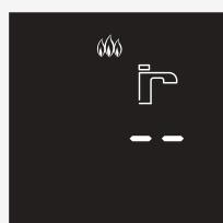
※ Режим «Нагрев бойлера» может работать одновременно с режимом «Отопление».
