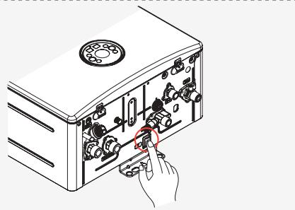
※ В обычном режиме кнопка аварийного запуска выключена.
