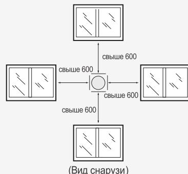
• Расположение дымохода относительно стен и потолка
