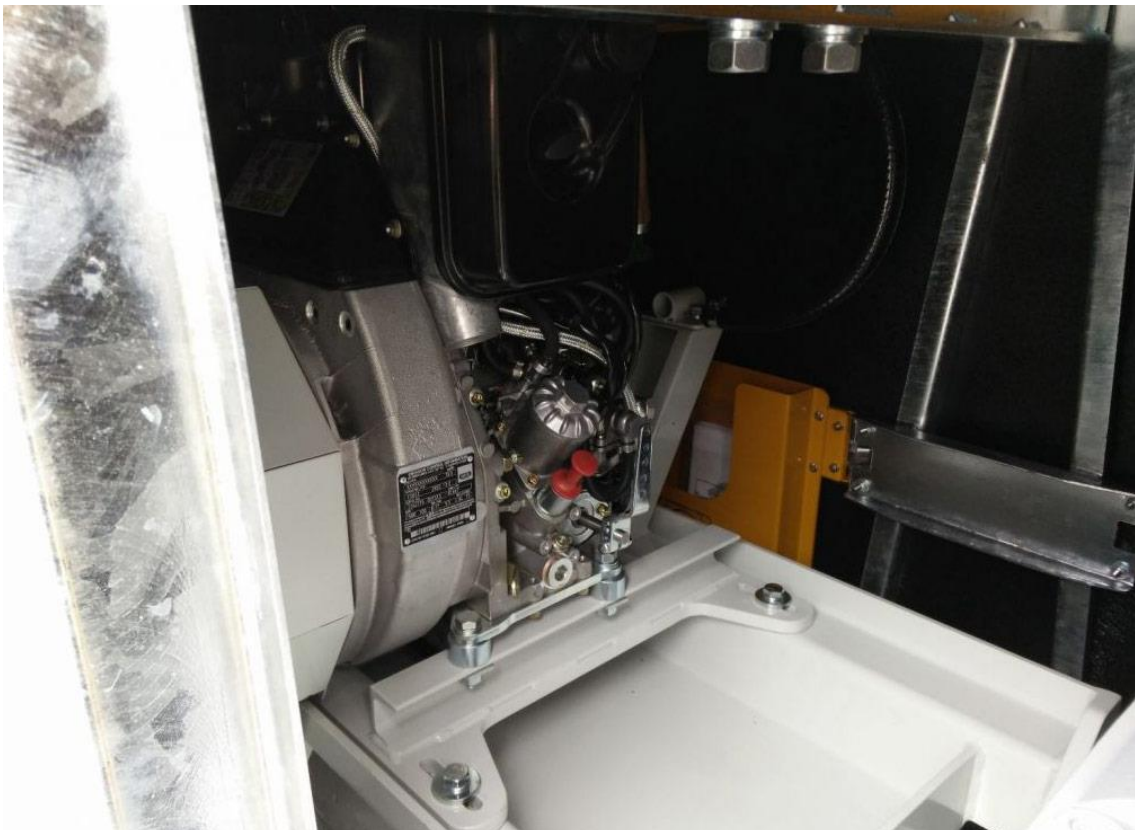
Емкость для сбора конденсата предотвращает утечку жидкостей в окружающую среду. Специальная версия двигателя Hatz с увеличенной масляной коробкой.
