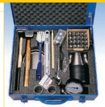
Инструмент для измерения содержания остаточной влаги в стяжках, действующий на основе химической реакции. Вода вступает в реакцию с карбидом кальция и образует газ ацетилен, который увеличивает давление. Уровень влажности определяется давлением, которое показывает манометр. Гидрометр поставляется в пластиковом футляре, который содержит:
