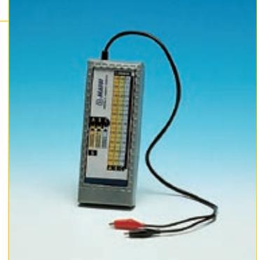
Электронный прибор для быстрого определения процентной влажности, содержащейся в стяжках из бетона (шкала А), стяжках на основе Марсеть (шкала В) или на основе ангидритного гипса (шкала С). Гидрометр получает питание от батареек мощностью 9В и поставляется в футляре, который содержит:
