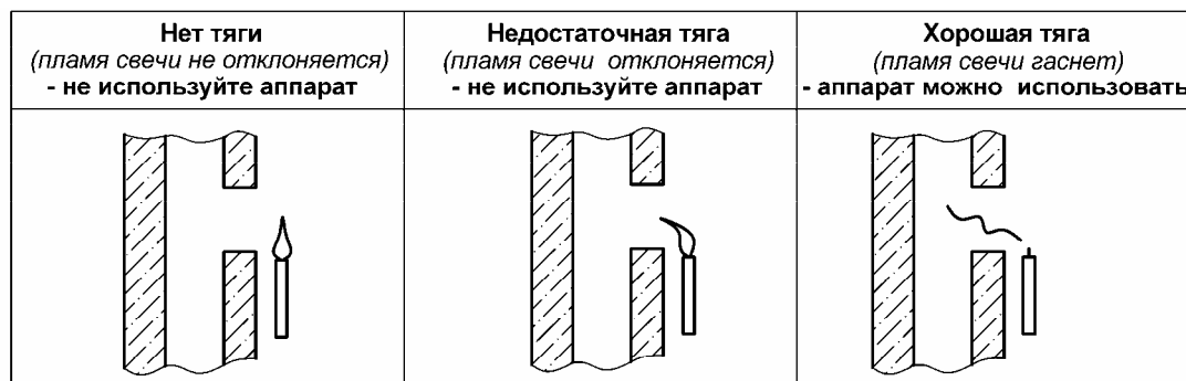
Рисунок 4. Способ проверки тяги в дымоходе
