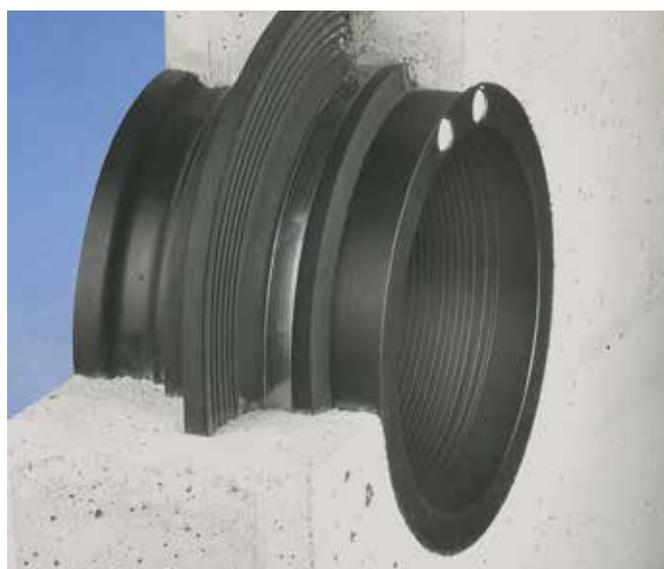
Муфта для присоединения к шахте SAM устанавливается вровень с опалубкой и заливается бетоном. Предварительно изготовленный паз гарантирует надежное анкерное крепление, которое дополнительно уплотняет гильзу.
