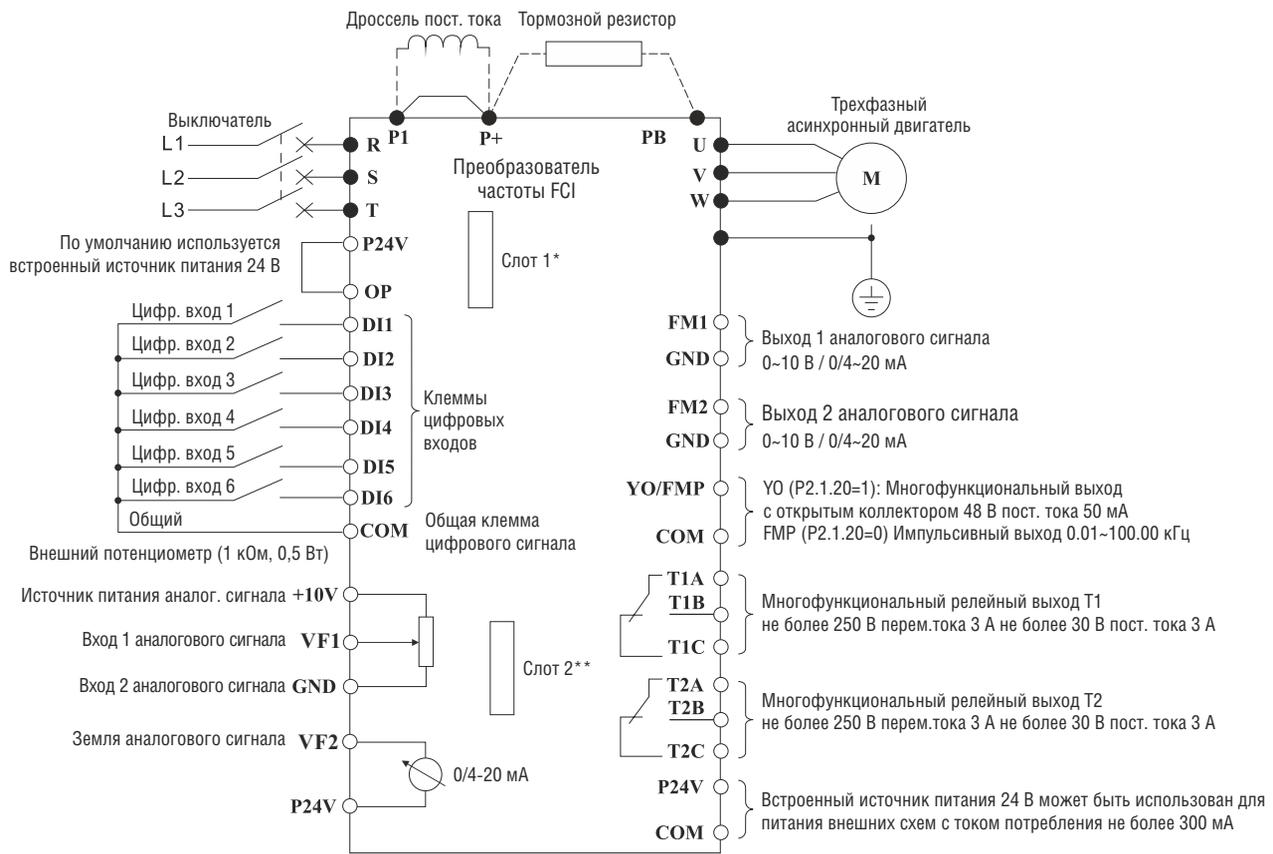
Стандартная конфигурация для преобразователей частоты мощностью 18,5 кВт и выше
