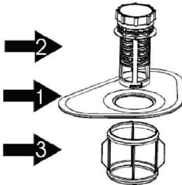
Для Вашего удобства мы поместили сливной насос и систему фильтров в легкодоступном месте внутри отсека. Фильтрующая система состоит из трех компонентов: основной фильтр, грубый фильтр и тонкий фильтр.
