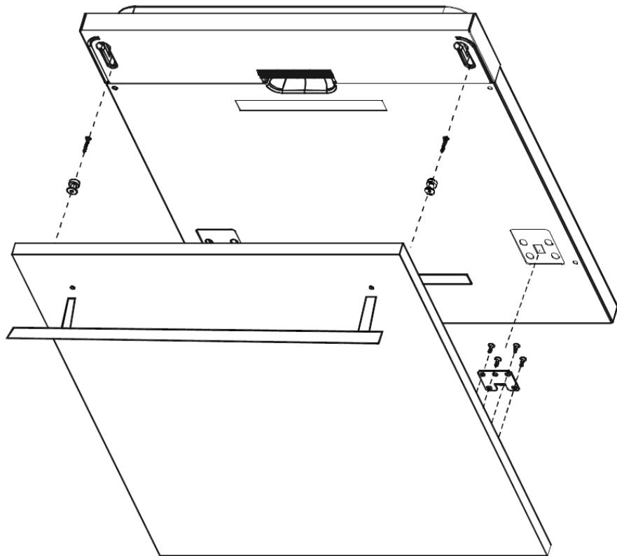
**ПОДГОТОВКА К УСТАНОВКЕ****РАЗМЕРЫ И УСТАНОВКА ВНЕШНЕЙ ПАНЕЛИ
