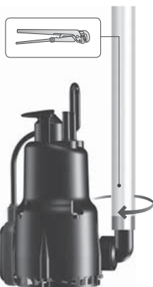
Рис. 8 Подключение напорной трубы
