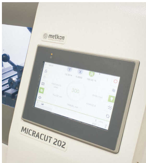
HMI сенсорное управление с различными методами, базой данных и мониторингом обслуживания
