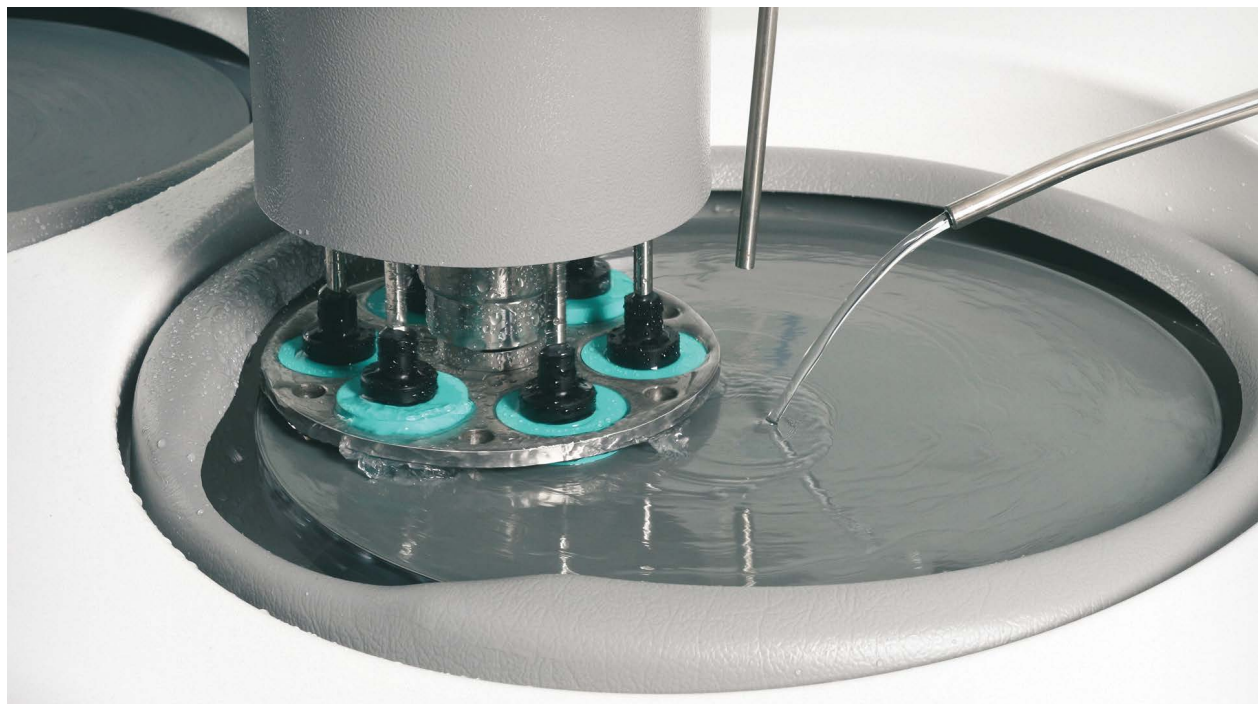
Автоматическая подача воды
