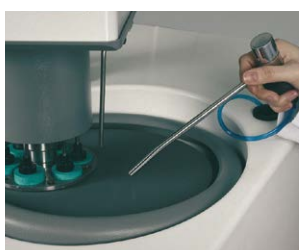
Вытяжной шланг подачи воды
