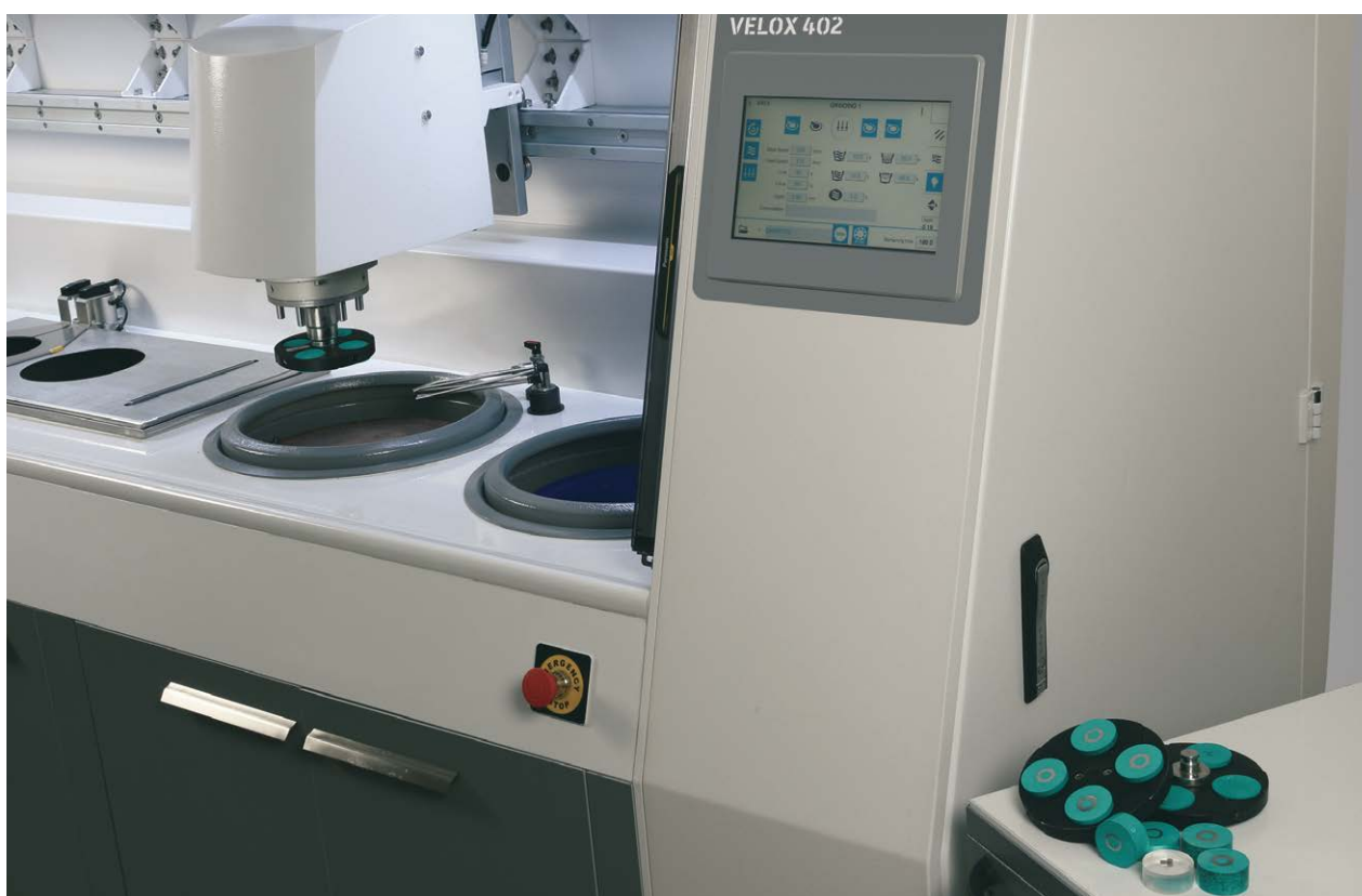
Полностью автоматическая шлифовально-полировальная система
