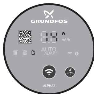
Рис. 13 Панель управления во время процедуры удаления воздуха После завершения процедуры удаления воздуха насос вернётся к первоначальным настройкам.
