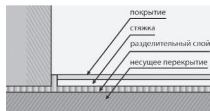
Рис. 14. Стяжка на разделительном слое
