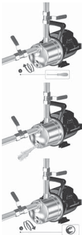
Рис. 13 Опорожнение насоса JP
