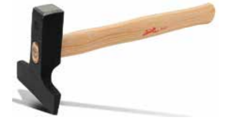
Т Кромковтирочный (компрессионный) молоток, (цельнокованный) 3кг Рекомендуется для притирки и разглаживания напольного покрытия в местах стыка и трудно доступных местах, не царапая поверхность
