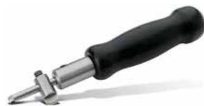
Резак с направляющей для разделки шва в линолеуме перед сваркой. Конструкция ножа позволяет прорезать шов точно по стыку
