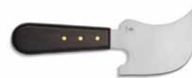
Месяцевидный нож Используется для удаления выступающей части шнура после сварки. Применяется с насадкой
