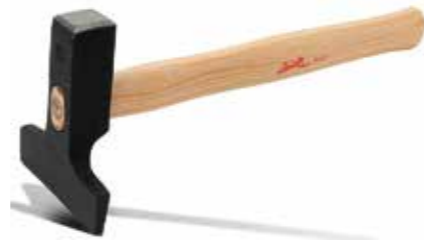
Т Кромковтирочный (компрессионный) молоток, (цельнокованный) 3кг Рекомендуется для притирки и разглаживания напольного покрытия в местах стыка и трудно доступных местах, не царапая поверхность
