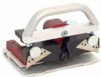
Линокат Отрезает верхний край материала, используя при этом нижний как базу. Два лезвия позволяют резать без линейки от стены к стене
