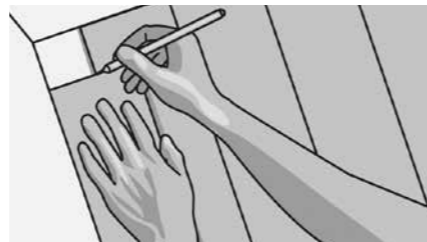
Рис. 109. Последний ряд досок перед укладкой необходимо тщательно измерить. Если он слишком широк, необходимо сузить доски до соответствующего размера. Обрезать доски нужно со стороны паза. После совмещения доски с остальными, дожать ее с помощью монтажного приспособления до устранения щелей.
