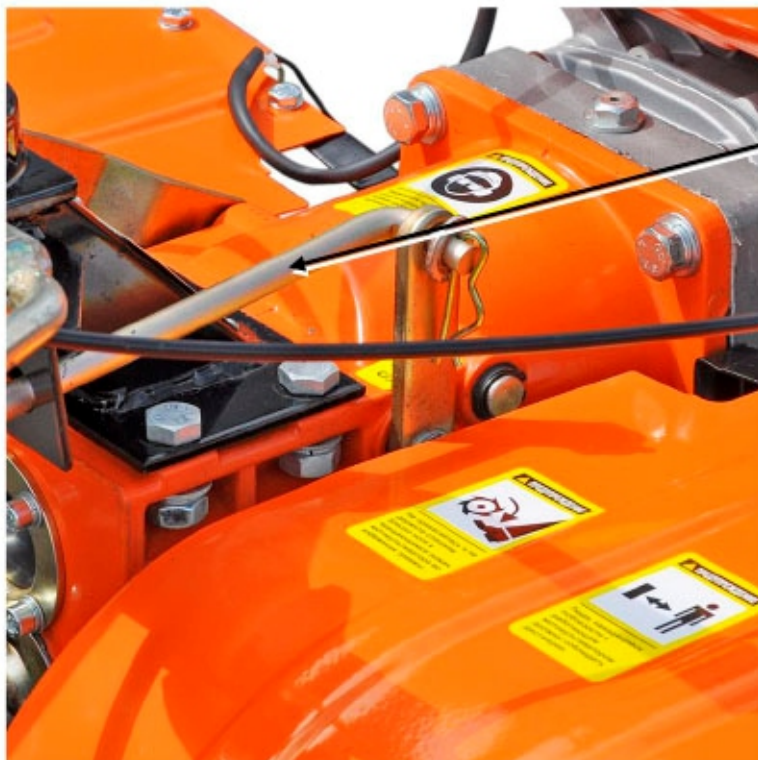
Зашплинтованный удлинитель рычага переключения передач
