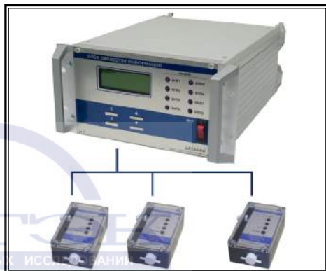
Схема прибора МГЛ-19М: блок обработки информации и блоки первичных преобразователей (БПП) - от 1 до 8 шт
