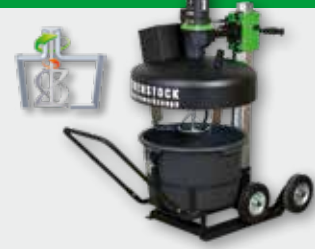
TwinMix 1800 T 1.800 Вт; 250/450 и. 20/36 мин -1 ; 65 л; Кол-во переш. материала 50 кг
