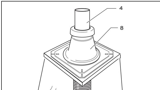
11. Наденьте оголовок шахты (8) на трубу устья (4) и поставьте ее в шахту.
