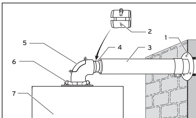
1. Выполните монтаж стенной накладки (1).
