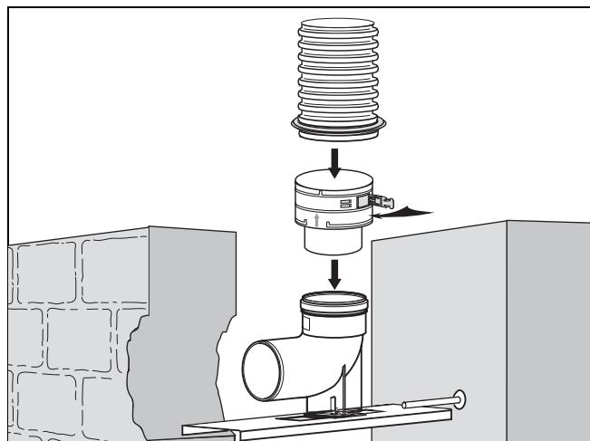
9. Смонтируйте уплотнение в самой нижней не поврежденной канавке дымохода.
