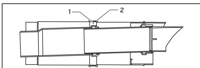
2. Отрегулируйте телескопический проход через стену на нужную длину.
