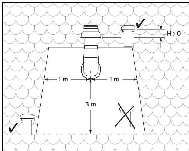
Из вытяжных каналов выходит очень влажный отводимый воздух. Он может конденсироваться в трубе подачи воздуха и вызывать повреждения изделия.
