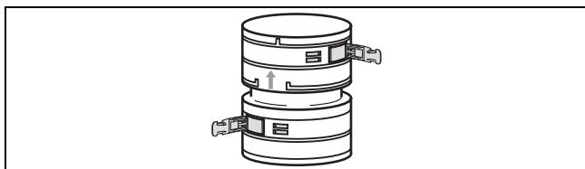
1. Чтобы не выполнять гибкий дымоход из одного элемента на всю длину, можно вставить несколько частей и соединить их соединительными элементами (арт. № 0020077525).
