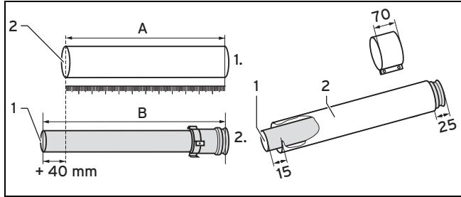
8. Сначала отмерьте необходимый кусок воздуховода\*(**A**), и затем рассчитайте длину соответствующего дымохода (**B**):
