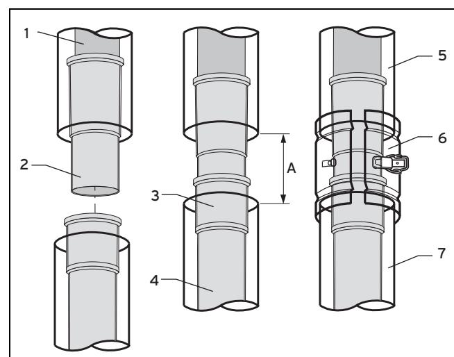
1. Наденьте разъединительное устройство (2) на дымоход до упора (1).
