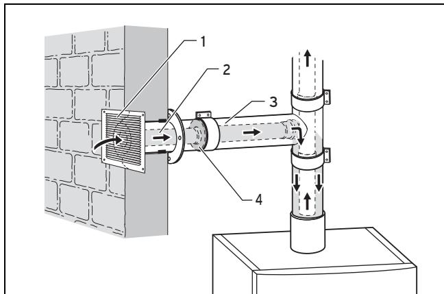
Приточный воздух поступает через вентиляционную решетку (1) и движется по внутренней трубе (2) системы труб концентрической формы. Кольцевая щель (3) перекрыта уплотнением (4), предотвращающим протекание через нее воздуха. Неподвижный слой воздуха в кольцевой щели действует в качестве теплоизоляции, предотвращая при низкой температуре наружного воздуха образование конденсата на поверхности наружной трубы.
