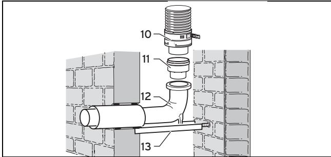
12. Вставьте переходник на 80 - 100 мм (11) в отвод с опорной консолью (12).
