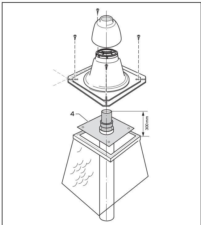
2. Только концентрический дымоход: установите уплотняющую пластину (4) на краю входа в шахту.
