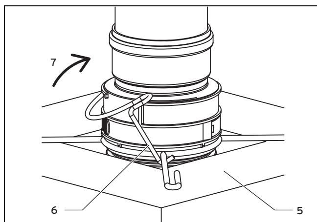
7. Зафиксируйте соединительный элемент наклонно расположенной трубы устья с помощью скобы к монтажной крестовине.
