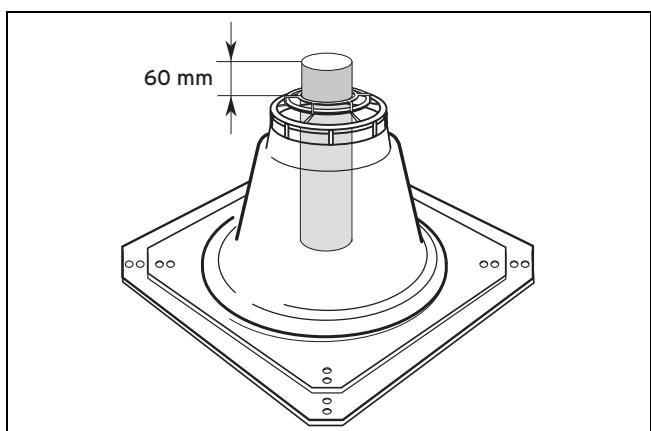
7. Проконтролируйте, чтобы над основанием оголовка шахты выступало 60 мм.
