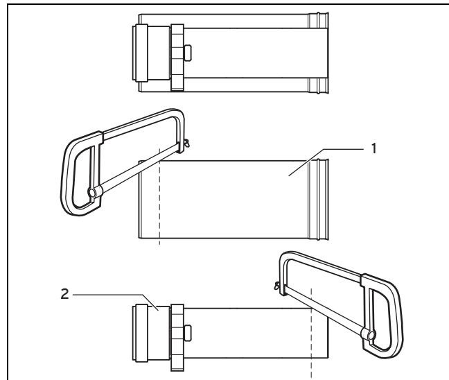
1. Для укорачивания удлинителя трубы отходящих газов (1) извлеките его из внешней трубы (2).
