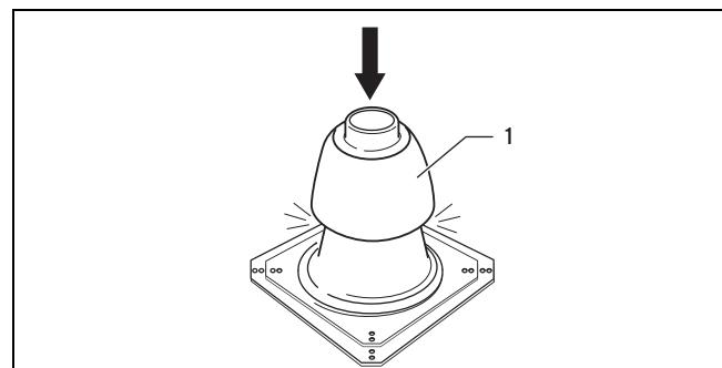
6. Наденьте колпак оголовка шахты (1) через верхний конец гибкого дымохода с прокладкой.
