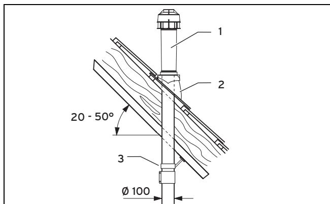
1. Выберите место установки прохода через крышу так, чтобы за изделием оставалось достаточное пространство для присоединения к системе отопления.
