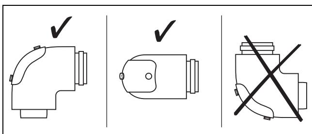
Неправильное монтажное положение вызывает выход конденсата из-под крышки смотрового отверстия и может стать причиной коррозионных повреждений.
