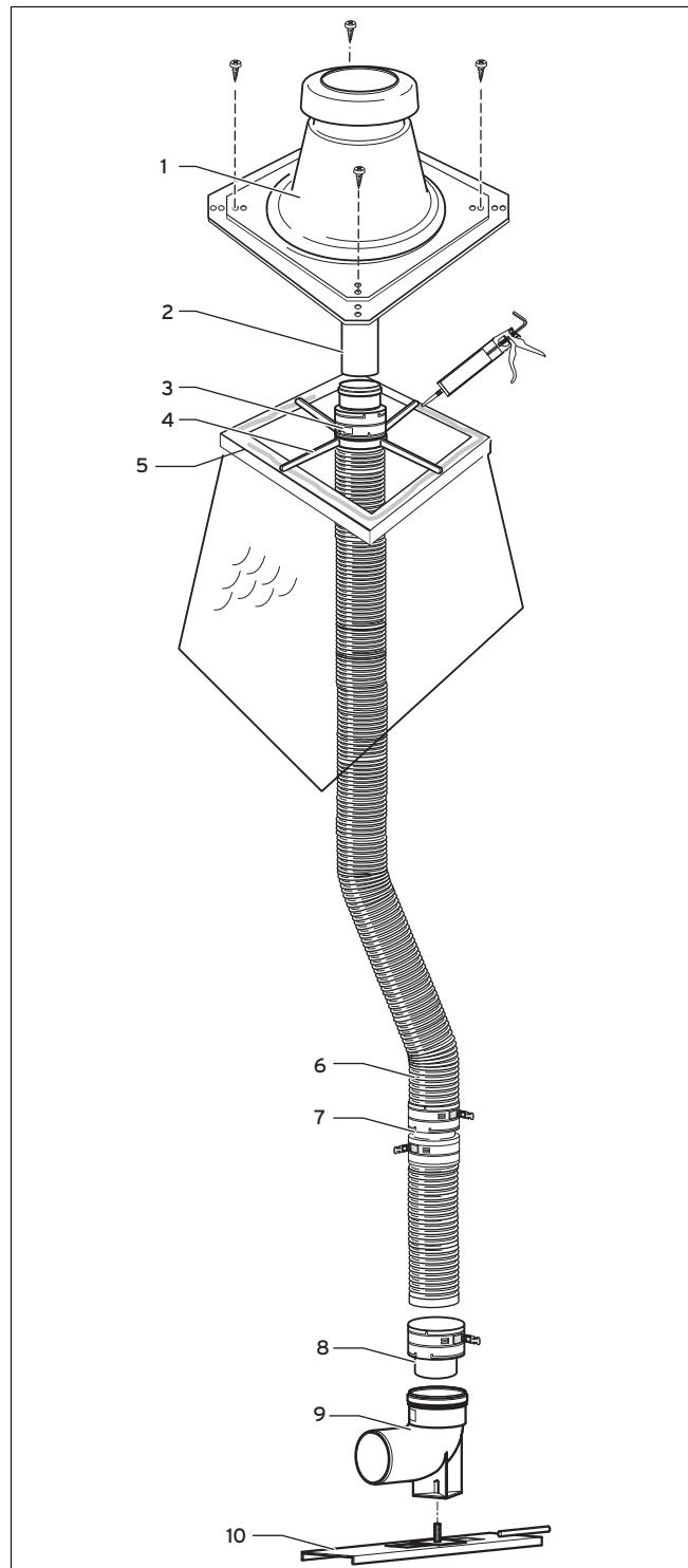
1. Определите общую длину гибкого дымохода (6) от входа в шахту (5) до отвода с опорной консолью (9).
