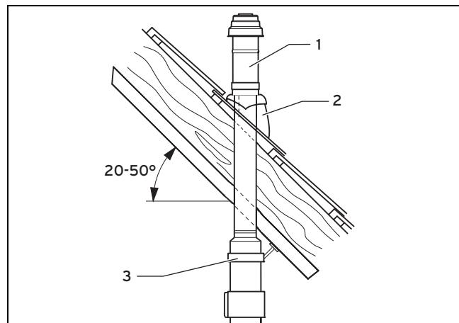
1. Выберите место установки прохода через крышу так, чтобы за изделием оставалось достаточное пространство для присоединения к системе отопления.
