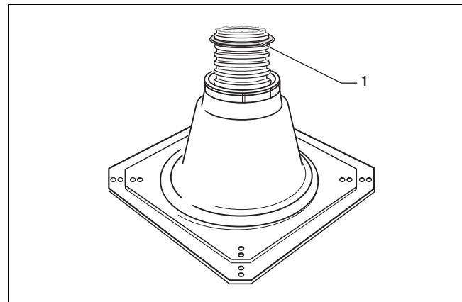
4. Теперь обрежьте гибкий дымоход с помощью пилы или ножниц по канавке таким образом, чтобы над краем основания выступали 4 - 5 канавок.
