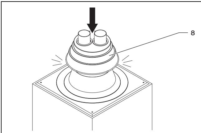
14. Наденьте верхнюю часть оголовка шахты (8) через обе устьевые трубы.
