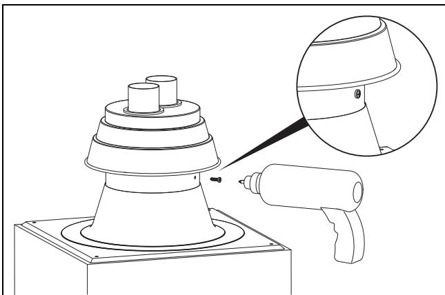
16. Чтобы жестко соединить верхнюю часть с нижней, выполните монтаж стопорных винтов-саморезов.
