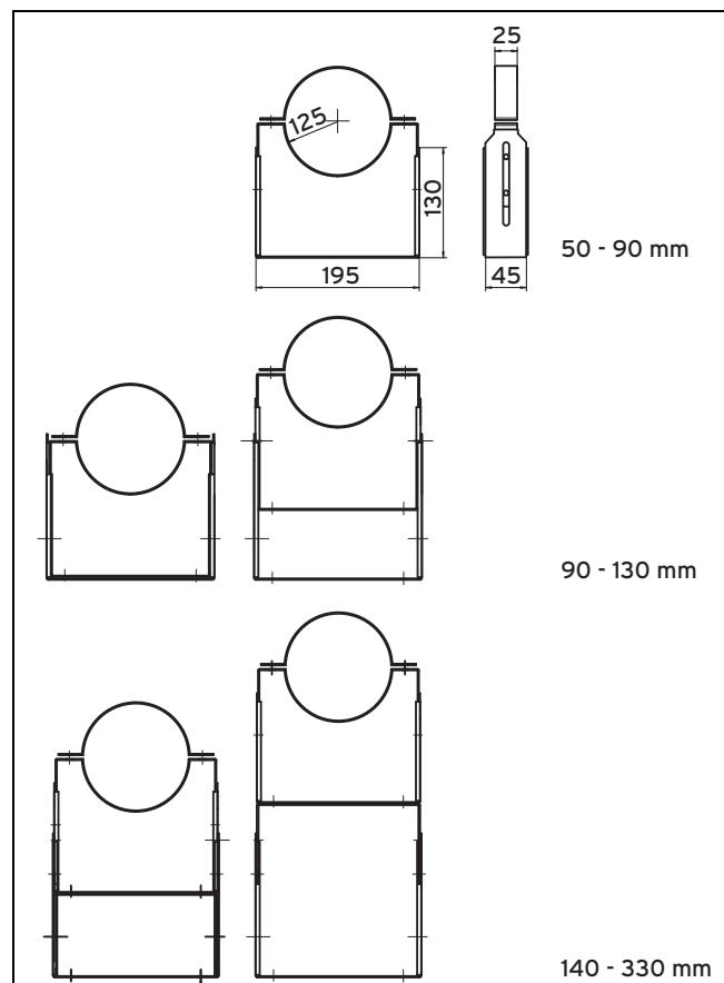
18. Для получения диапазона регулировки от 90 мм до 160 мм снимите внешнюю скобу.
