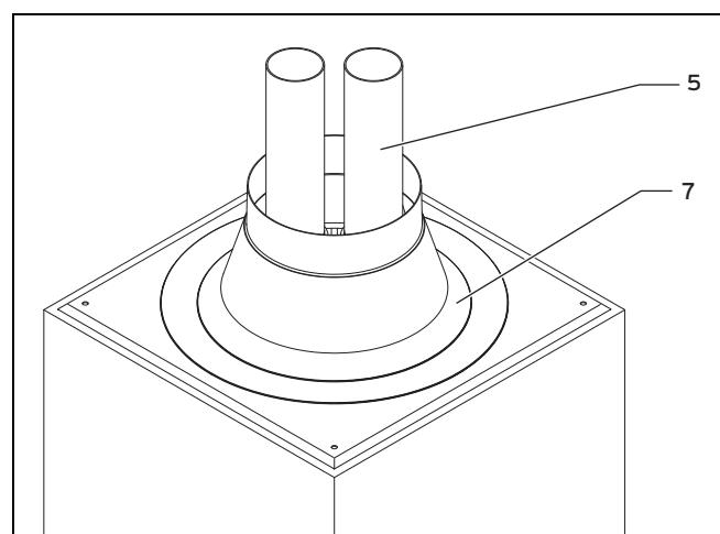
10. Наденьте оголовок шахты (7) через устьевые трубы (5) на шахту.
