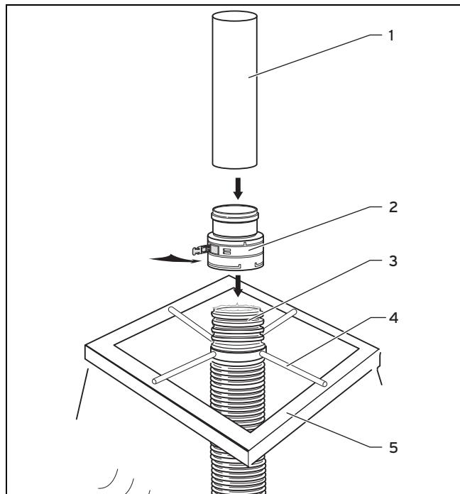
1. Надвиньте монтажную крестовину (4) через дымоход (3) на стенку шахты.
