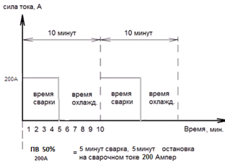
График продолжительности полного цикла работы сварочного генератора
