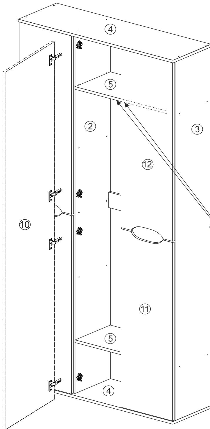
12. На створку 10 приклейте зеркала при помощи скотча двухстороннего и клея для зеркал. Далее необходимо прикрепить полунакладные петли, используя шурупы 4\*13 мм. Навесить готовый фасад.
