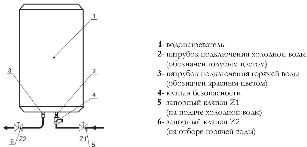
Рис.2 Схема подключения водонагревателя к водопроводной сети
