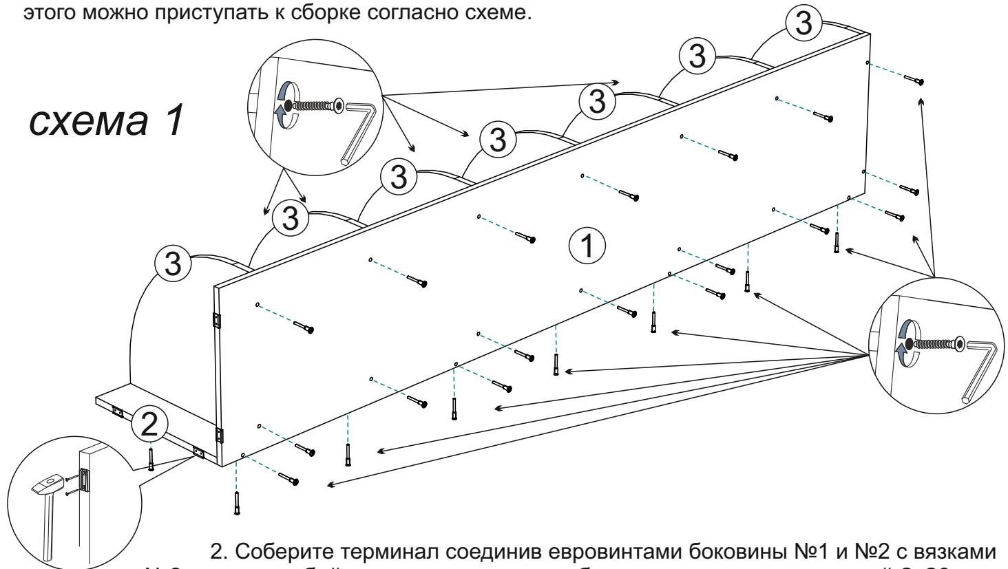
2. Соберите терминал соединив боковины №1 и №2 с вязками №3, затем прибейте подпятники на низ боковин при помощи гвоздей 2x20, как показано на схеме 1.
