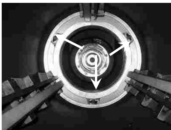
Рис. 4.4: Расположение фиксируемого быстроизнашиваемого кольца с обозначением точек фиксации
