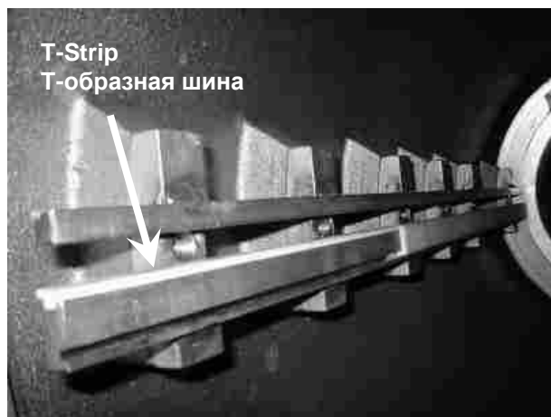
Рис. 4.3: Сепаратор S 855 с направляющей шиной сита с G-образным пазом: с G-образной шиной для стандартного сита в зоне обезвоживания и T-образной шиной для сита тяжелой конструкции в зоне прессования
