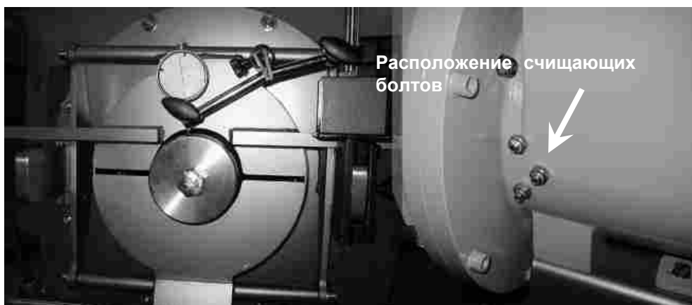
Рис. 4.11: Контроль косога витка шнека (слева), регулировка счищающих болтов (справа)
