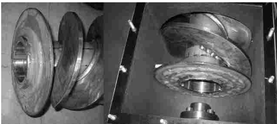
Рис. 4.10: Шнек с концевым диском в качестве дополнительной защиты редукторного двигателя
