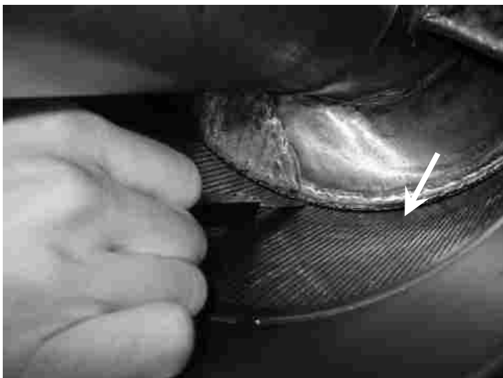
Рис. 4.12: Измерение рабочего зазора между ситом и шнеком
