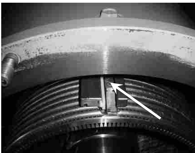
Рис. 4.7: Установочная позиция сита, отштампованный треугольник сверху и вперед к сепаратору
