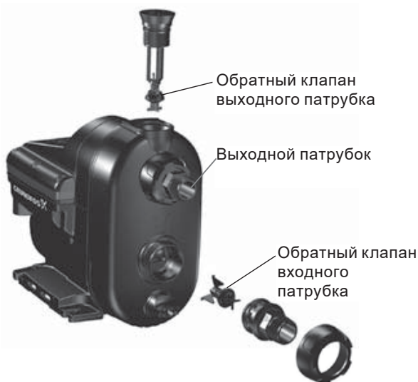
Рис. 20 Обратные клапаны входного и выходного патрубков
