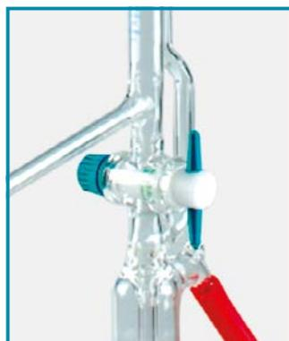
Все автоматические бюретки оснащены промежуточным краном из PTFE, обеспечивающим надежное, быстрое и точное измерение.
