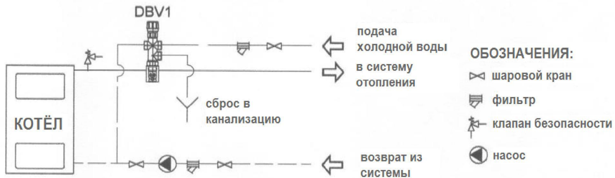
Рис.6 Схема установки с двухходовым клапаном безопасности DBV1.
