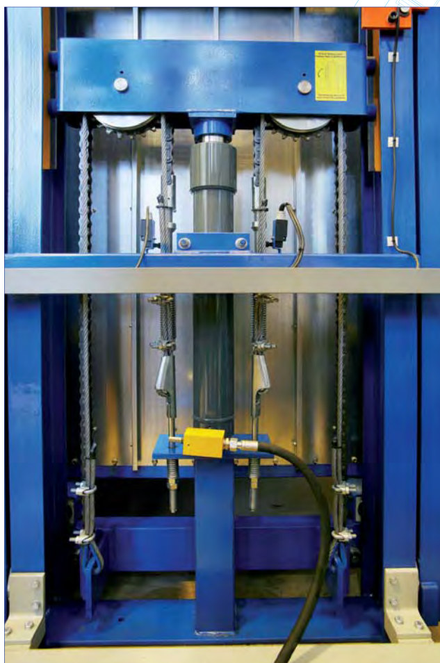
Рис 7. Вид сзади на нижнюю часть направляющей стойки, с монтированными на неё частями подвески.
