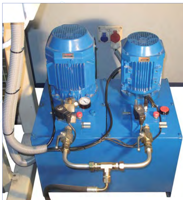
Рис. 17. Гидравлическая силовая установка.
