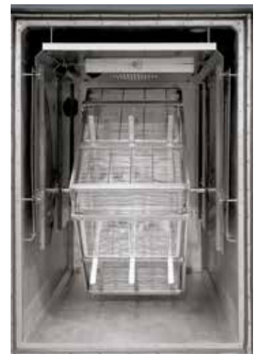
Поворотная тележка с моторным приводом и коробами для перемещения материала во время его тепловой обработки
