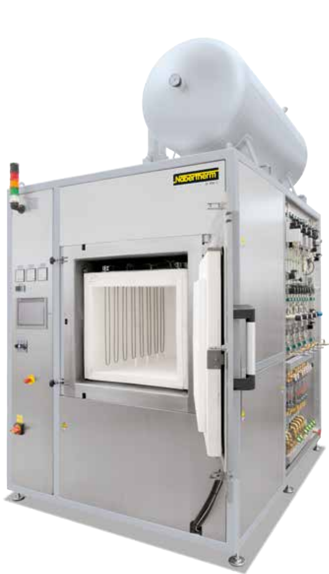
Ретортная печь VHT 100/15-KE H 2 с волокнистой изоляцией и расширительным пакетом для работы в водородной среде, 1400 °С
