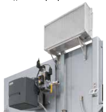
Прямой газовый обогрев в сушильной камере
