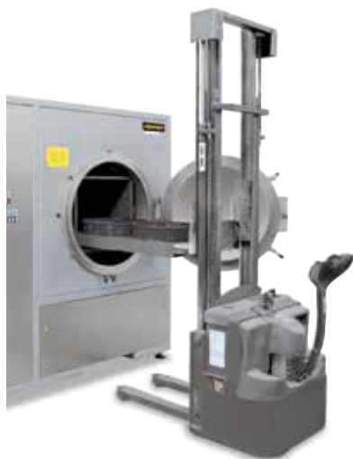
Загрузка ретортной печи NRA 300/06 с помощью автопогрузчика
