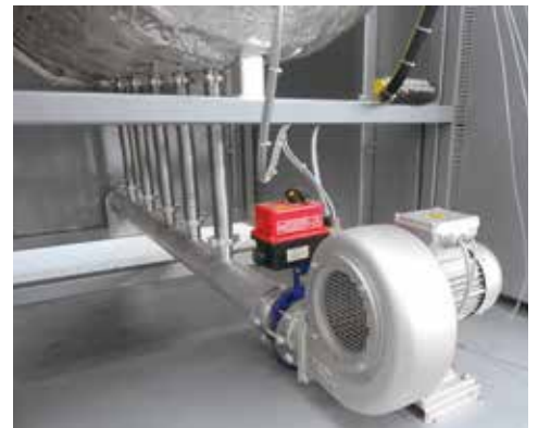
Охлаждение воздуходувкой ретортной печи с горячей стенкой NRA 400/03
