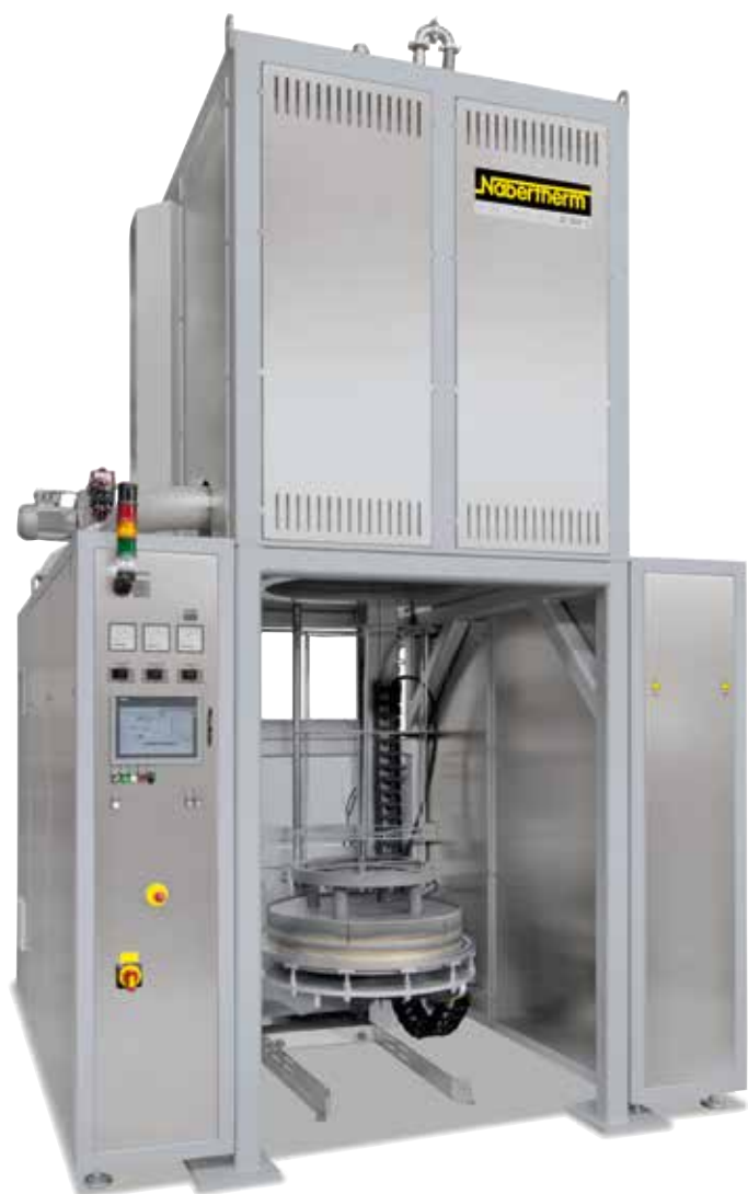
Ретортная печь с подъемным подом LBR 300/11 H 2 с предохранительными устройствами для работы с водородом в качестве технологического газа
