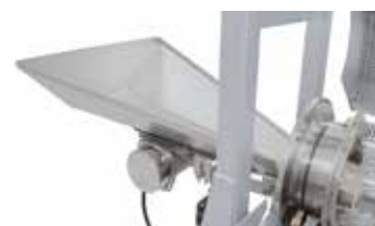
Виброжелоб и удлинитель на поворотной трубе для простой загрузки
