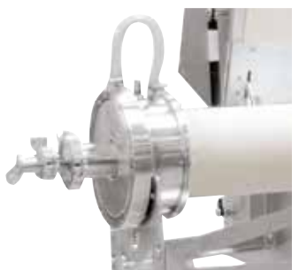
Вакуумный фланец с водяным охлаждением
