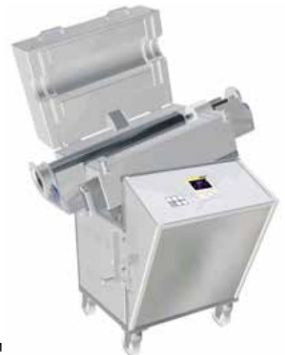
Вращающаяся трубчатая печь, наклоненная влево для опорожнения
