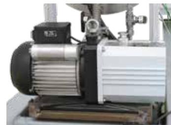
Вакуумный насос для холодного вакуумирования реторты
