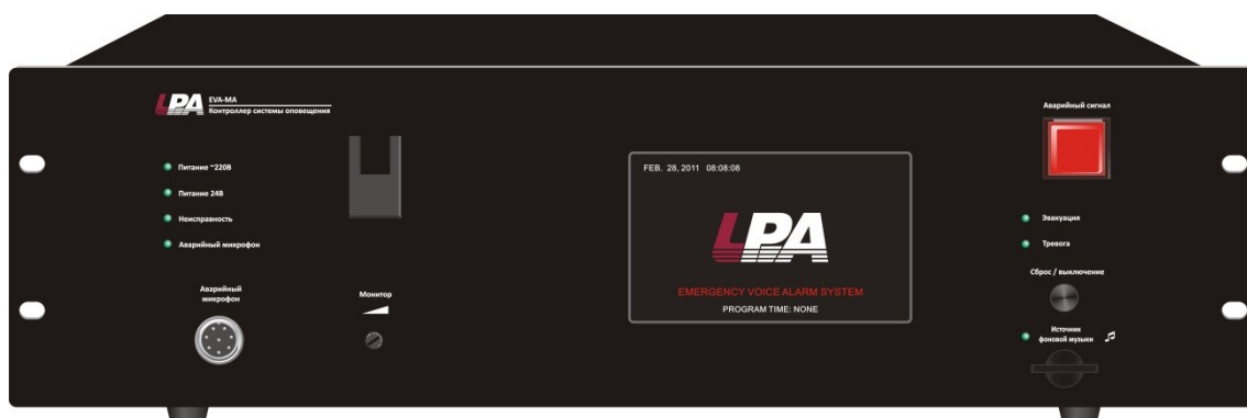
Рис. 3.1. Внешний вид контроллера LPA-EVA-MA
