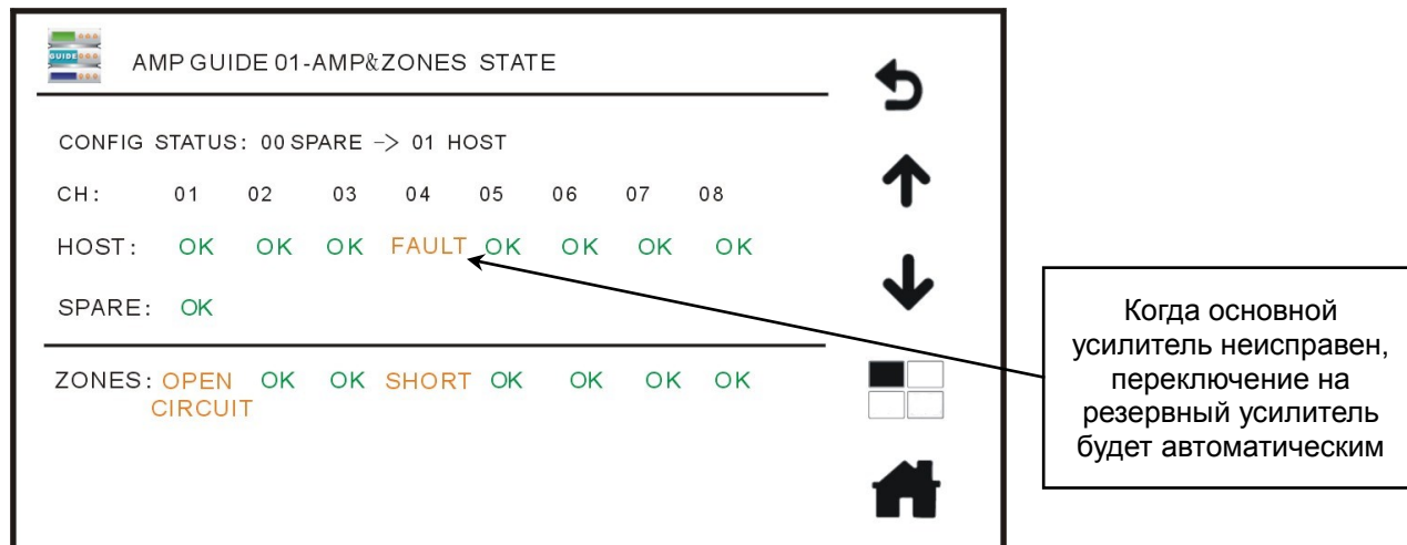
Рис. 4.13. Состояние переключения на резервный усилитель в окне
