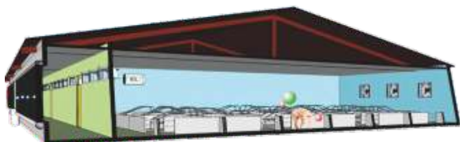
Подача подготовленного воздуха в секцию содержания
