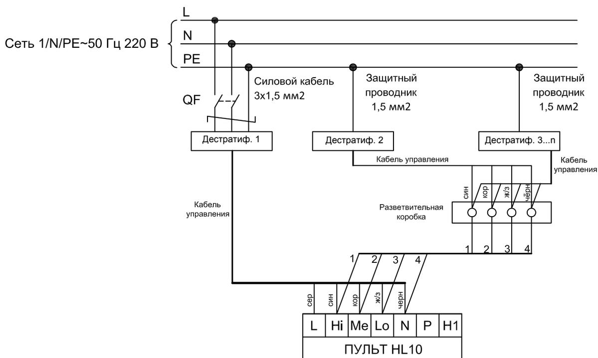
Рисунок 4. Схема подключения одной группы дестратификаторов к ПКУ-W1 (ver 1.0)
