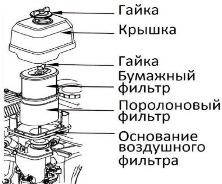
Рис. 7 – Устройство воздушного фильтра
