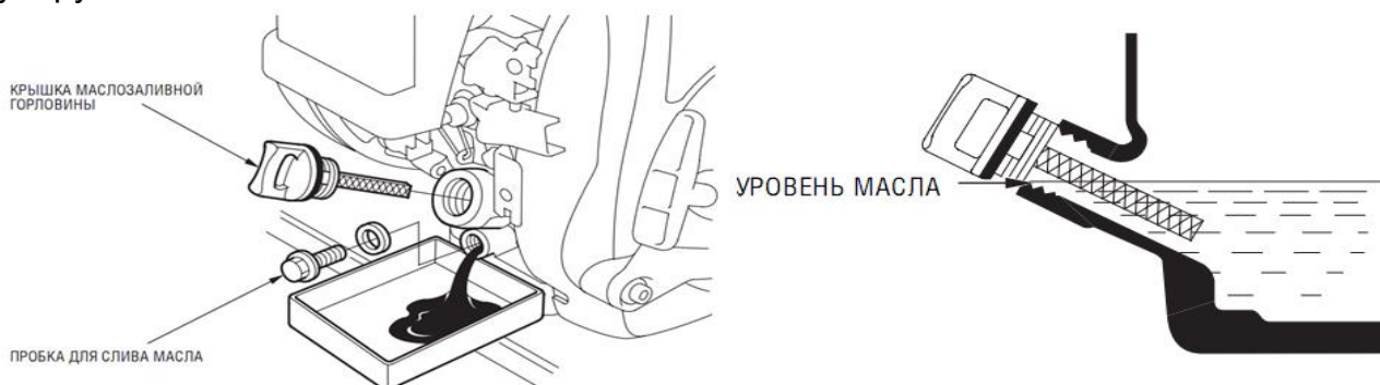
Рис.16 – Замена моторного масла
