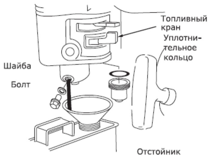
Рис. 14 – Слив топлива и очистка отстойника топливного крана
