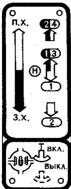
Рукоятка управления блокировкой дифференциала 10 (рис.3) установлена на пульте рулевой штанги. Переднее положение рукоятки соответствует включенной блокировке, а заднее – выключенной блокировке дифференциала (рис.4).
