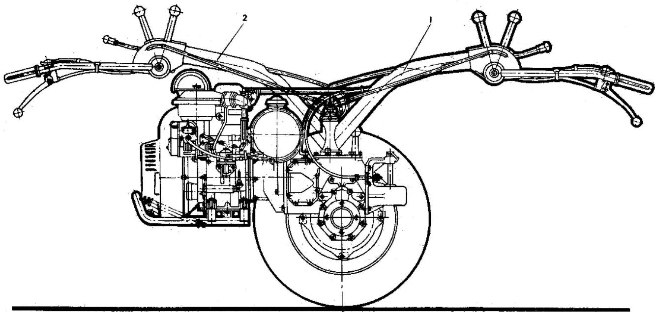
Рисунок 18 – Схема положения рулевой штанги
