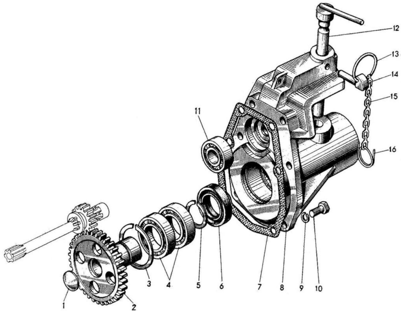
Рисунок 10 – Вал отбора мощности и прицепное устройство
