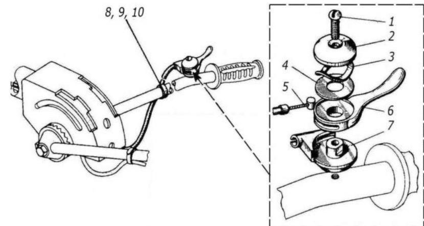
Рисунок 1 – Управление подачей топлива
