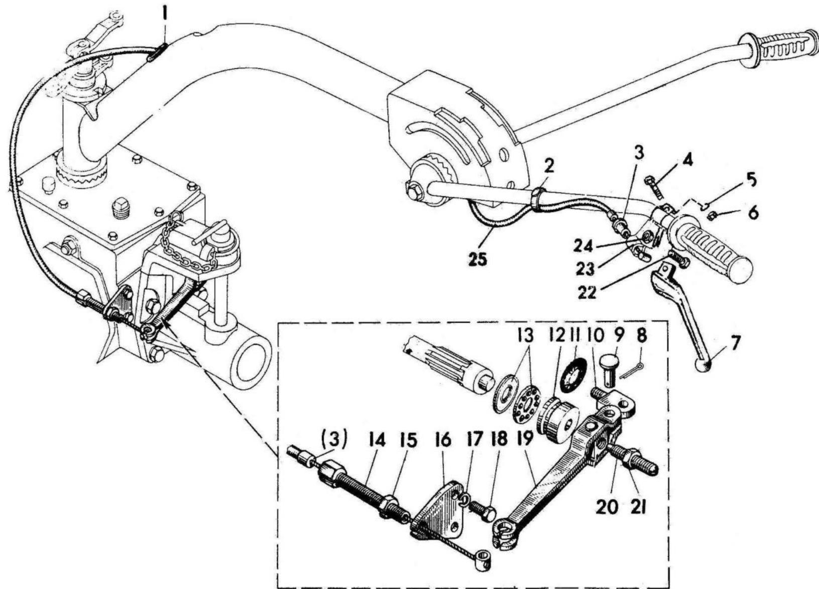
Рисунок 3 – Управление сцеплением
