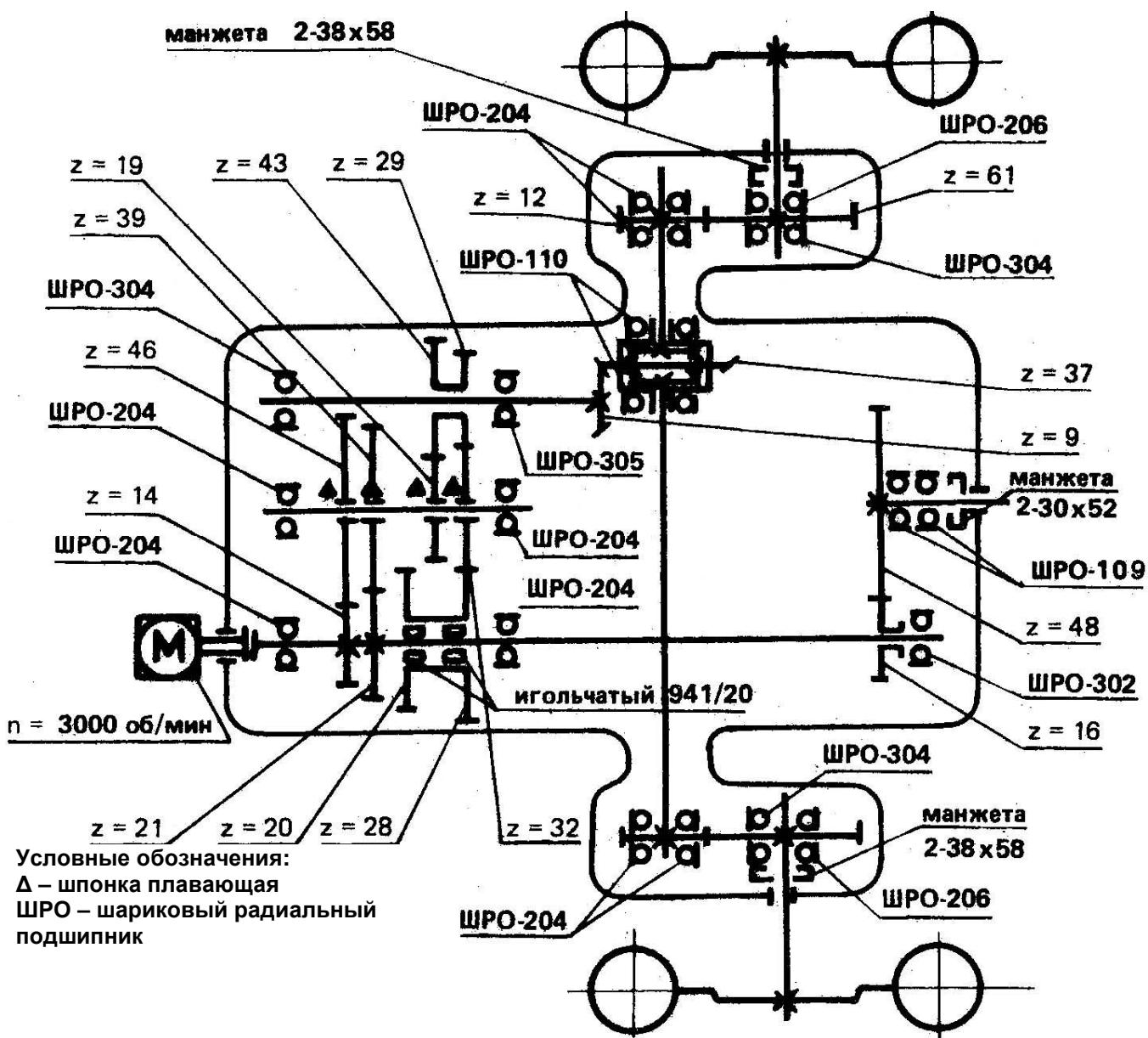
Рисунок 5 – Кинематическая схема силовой передачи мотоблока
