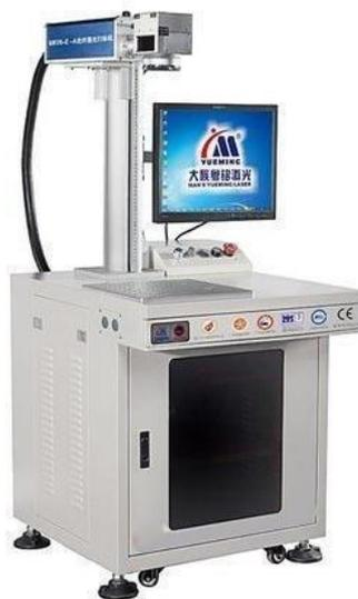
Используется для обработки металла с высоким отражением (алюминий, медь, металл и серебро), а также пластиковых, стеклянных и керамических поверхностей.
