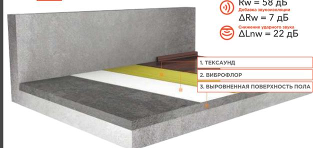
Самая тонкая система. Применяется в случаях, когда уже залита стяжка и имеются ограничения по толщине конструкции пола.
