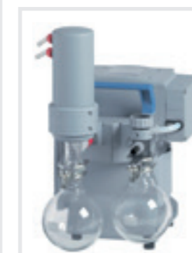
Vacuubrand MZ 2C NT AK+EK (2,0m³/h, достигаемый вакуум 7 mbar)
