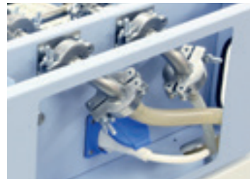
Автоматическое регулирование вакуума, в том числе два фланца DIN 16 и силиконовые шланги (Ø 8x18 мм)
