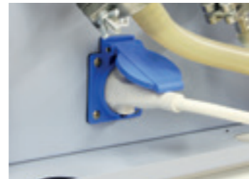
Штепсельная розетка для подключения и управления вакуум-насосом
