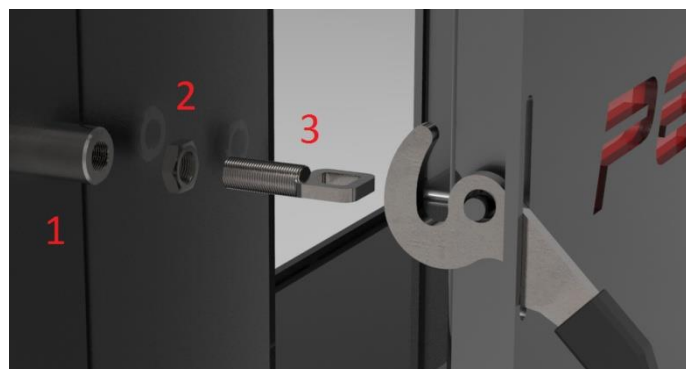
Рис.16 Схема подтяжки ручки типа «Серп»
