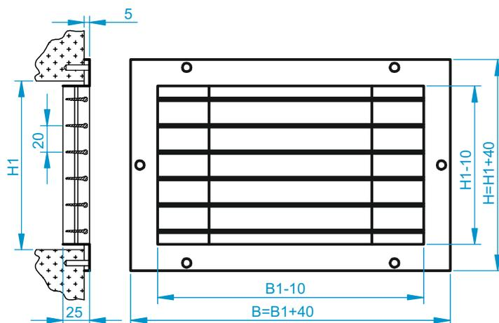
При необходимости регулировки объема воздушного потока (регулировки живого сечения) решетки комплектуются клапаном расхода воздуха (**клапан Б1** или **клапан Б2**).
